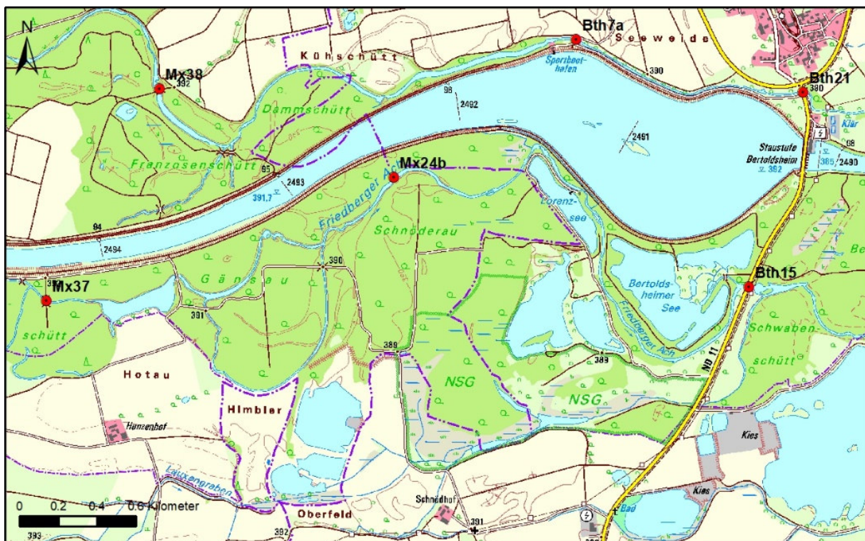
Abbildung 36: Pegel-Messstellen an Oberflächengewässern im Modellgebiet.
